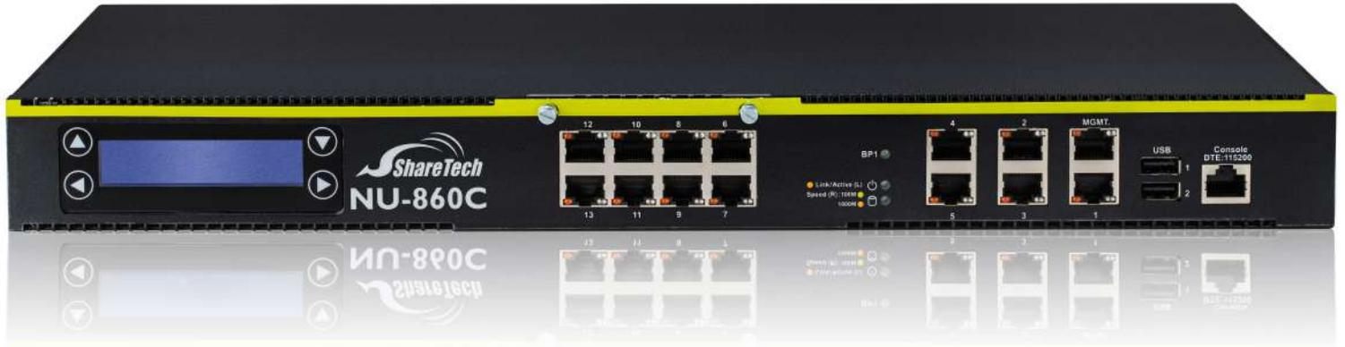
眾至Next Generation UTM網路安全設備具有高運作效能、多重安全防護機制及分層授權管理等特色，是中大型企業首選的網路安全及管理設備。NU-860C 具有新世代防火牆的強悍功能，包含以Deep Packet Inspection(DPI) 為基礎的應用程式辨識及管制、IPS、SSL解析與阻擋、Web Filtering、頻寬管理、防毒、垃圾郵件過濾及支援外部認證整合等功能，可以阻止駭客惡意潛入攻擊或未授權存取內部網路資源。亦支援雙機備援機制(HA)，可確保設備運作不斷線。
