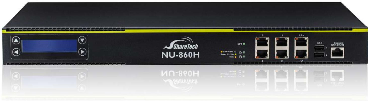
眾至Next Generation UTM網路安全設備具有高運作效能、多重安全防護機制及分層授權管理等特色，是中大型企業首選的網路安全及管理設備。NU-860H 具有新世代防火牆的強悍功能，包含以Deep Packet Inspection(DPI) 為基礎的應用程式辨識及管制、IPS、SSL解析與阻擋、Web Filtering、頻寬管理、防毒、垃圾郵件過濾及支援外部認證整合等功能，可以阻止駭客惡意潛入攻擊或未授權存取內部網路資源。亦支援雙機備援機制(HA)，可確保設備運作不斷線。
