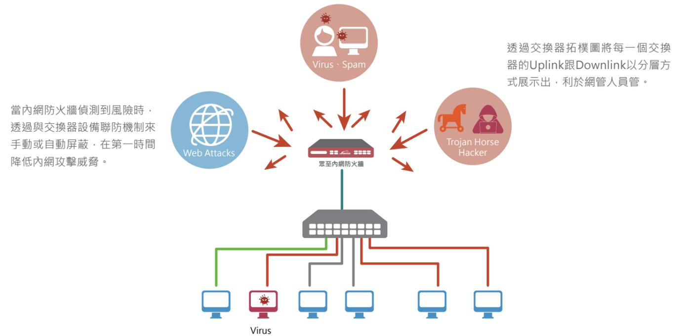
當內網防火牆偵測到風險時，透過與交換器設備聯防機制來手動或自動屏蔽，在第一時間降低內網攻擊威脅。
